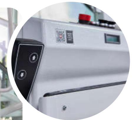
Detail ovládacího panelu plošiny s tlačítky pro pohyb nahoru a dolů.
